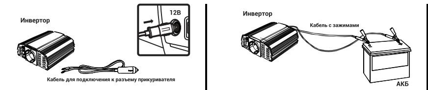
Рисунок 6.1: Подключение инверторов KV-M300/KV-M500/KV-P300/KV-P600
